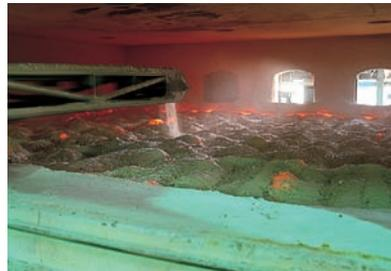
電気溶融炉の中心は約 1,600℃。耐熱ガラスの原料は高温でなければ溶けません。一日におよそ 20t 分、ガラス自体を導体にして炉の中で平均的にガラスを溶融することができます。
