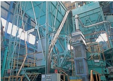
硼砂などを空気の勢いでミキサーへ送りこんで調合します。調合されたガラス原料はコンピュータ制御のコンベアによって溶融炉へ運ばれます。
