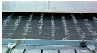
印刷を終えた製品は、デコレイティング・レアと呼ばれる焼き付け炉で、印刷されたプリントを焼き付けて乾かします。
