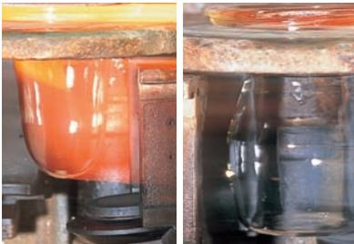
16ヘッドの自動成形機により、約 1,300℃になっている球形のガラスを平坦にのぼします。ガラスを回転させ、ブロー圧と遠心力で形を整えながら、製品の基本形を1分間に平均 25 個作ります。
