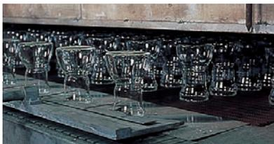
レア（徐冷）炉で約620℃の高温に熱し、次に低温状態へゆっくり移してガラスのひずみをとります。ひずみをとることで加工しやすくなります。
