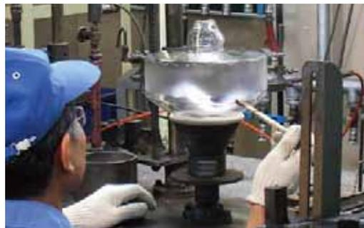
「ガラスのコーンスピーカー『<sup>はりおん</sup> 玻璃音』」はガラス製のサブウーファー1台とミドルレンジ2台、これにツイーター2台(アクリル製)を加えたスピーカーセットで構成されています。ガラス成形を行うガラス職人中心としたスタッフ23名が、約3年8ヶ月をかけて手作りで製作いたしました。特に今回、特許出願中のコーン(振動板)部分の製作では、薄さ0.5~0.8mmの薄くて割れやすいガラスの切断に、何回もの試作と挑戦を繰り返して作り上げています。通常のコーンに使用される紙などの素材と違い、ガラス素材は湿気に強く、硬度が高いため、ゆがみが少ないといった特徴があり、特に低音域では迫力のある良音をだすことができます。
